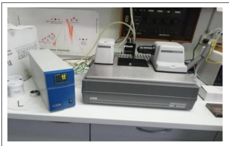
Slika 11. FT-IR spektrometar ABB Bomem MB102 i grijač s regulatorom temperatura Specac 3000 Series. 20
