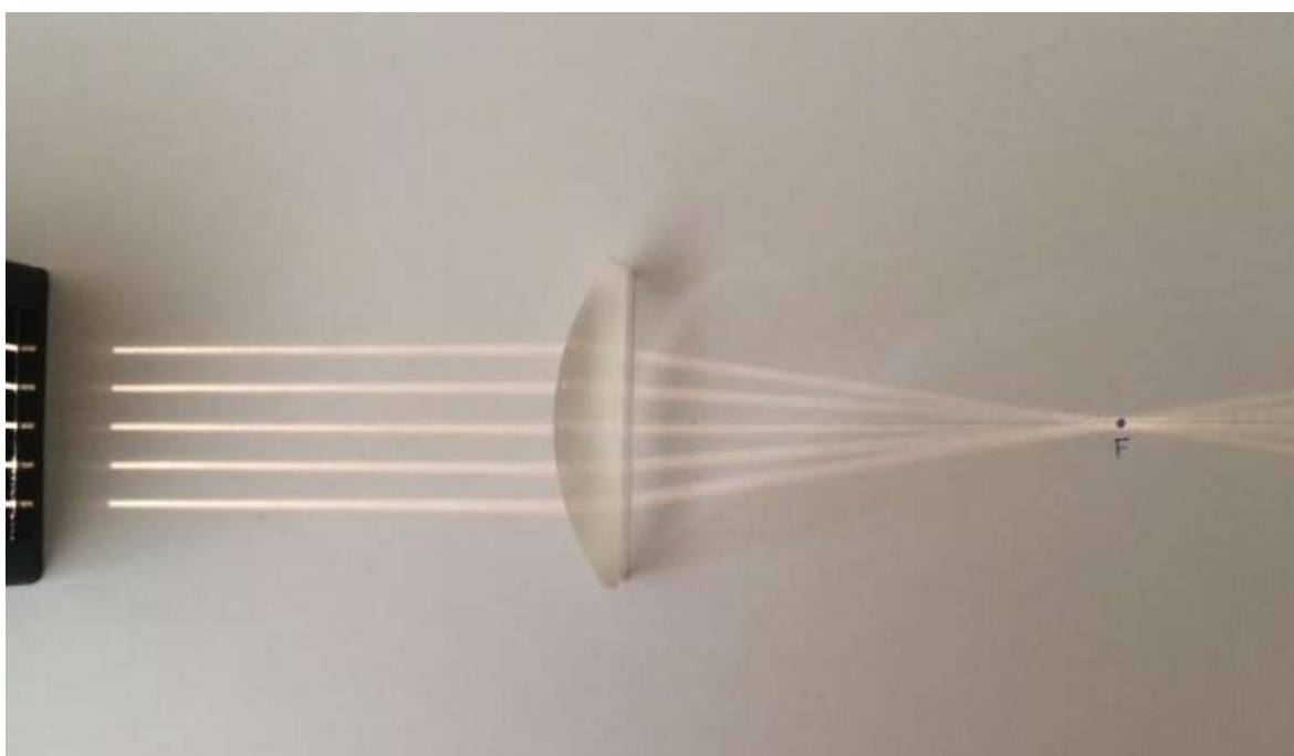
Slika 3: Lom paralelnih zraka svjetlosti kroz konvergentnu leću. Preuzeto iz [18].
