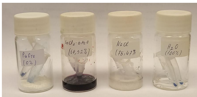
Slika 14. Uzorci spojeva 1 \cdot 6\text{H}_2\text{O} i 4 \cdot 4\text{CH}_3\text{OH} \cdot \text{H}_2\text{O} u komorama različitih relativnih vlažnosti zraka (0 %, 64,92 %, 75,47 % i 100 %)
