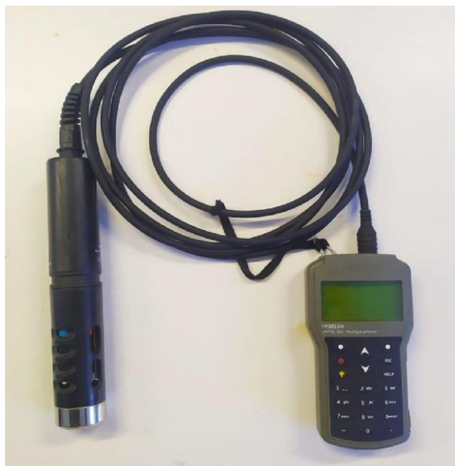
Slika 7. Prikaz višeparametarske sonde Hanna HI98194, pomoću koje sam mjerio parametre temperature, pH, oksido-redukcijskog potencijala, vodljivosti i koncentracije otopljenog kisika morske vode
