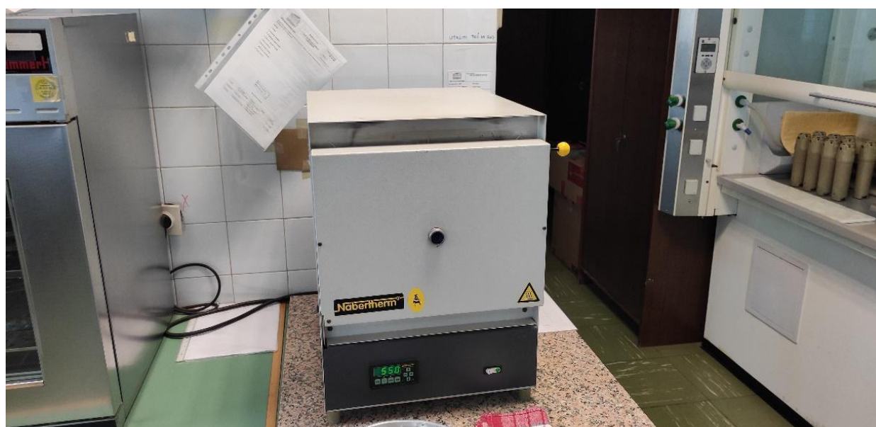
Slika 13. Prikaz električne peći za spaljivanje uzoraka Nabertherm L5/11/B410.
