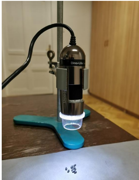
Slika 6. Fotografiranje biljnih makrofosila kamerom digitalnog mikroskopa DinoLite
