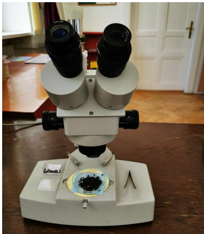
Slika 5. Binokularna lupa za izolaciju i determinaciju biljnih ostataka
