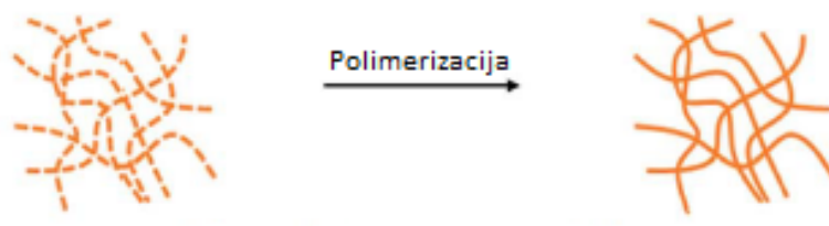
Slika 17. Ilustracija polimerizacije gelskih vlakana 78 .
