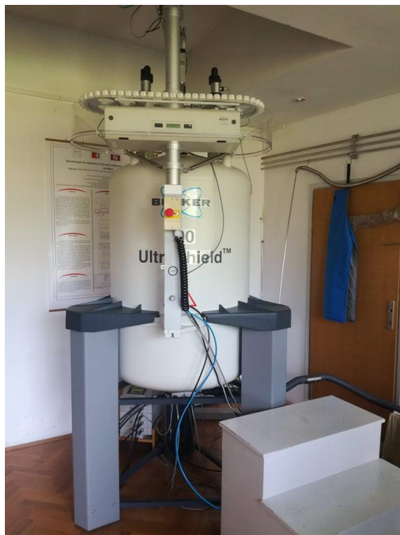
Slika 27. Bruker Avance AV600 instrument
