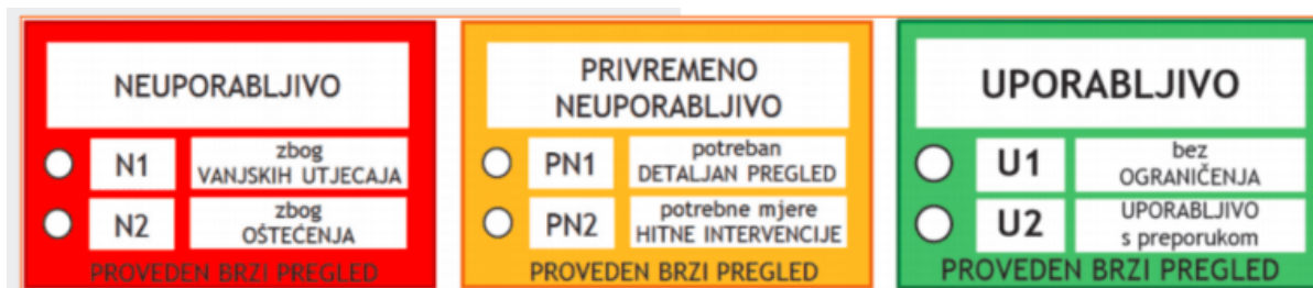
Sl.13. Naljepnice za ocjenu uporabljivosti građevina nakon zagrebačkog potresa
