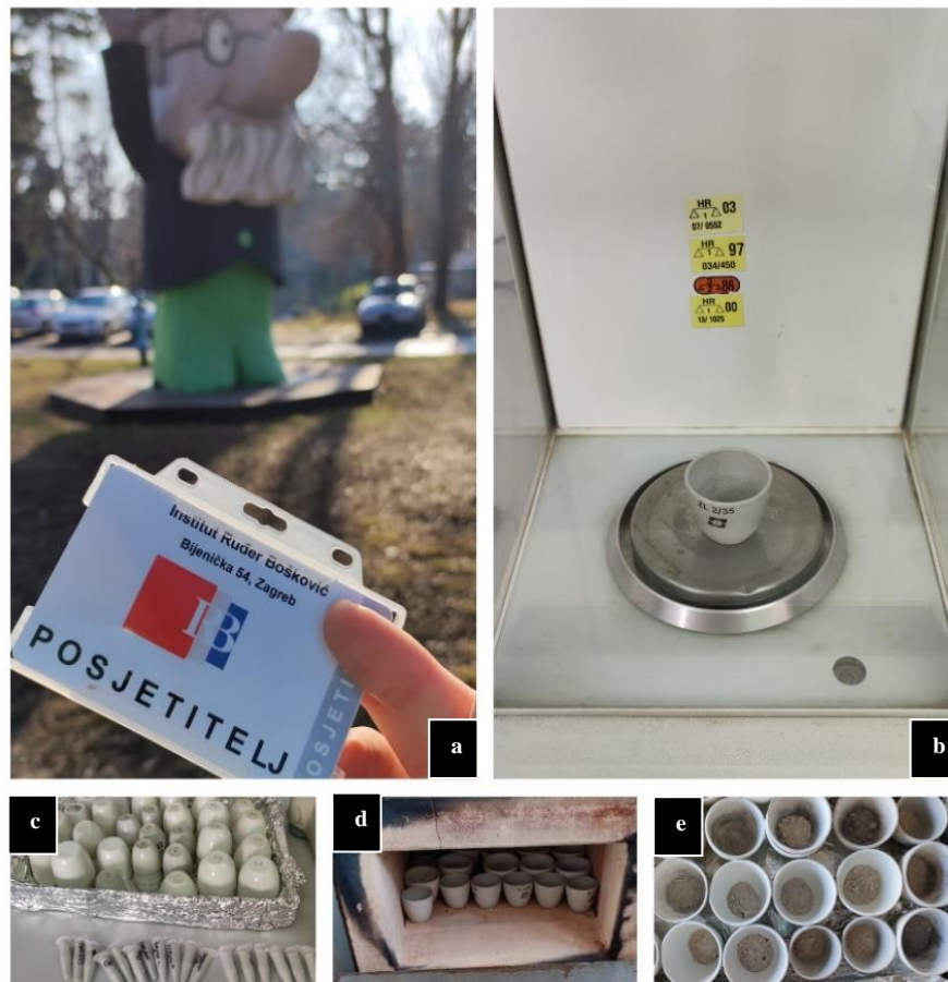
Slika 7. a – posjet IRB-u; b – vaganje uzorka za metodu žarenja; c – keramičke posudice i kivete s usitnjenim materijalom; d – uzorci u peći za žarenje; e – uzorci nakon žarenja.
