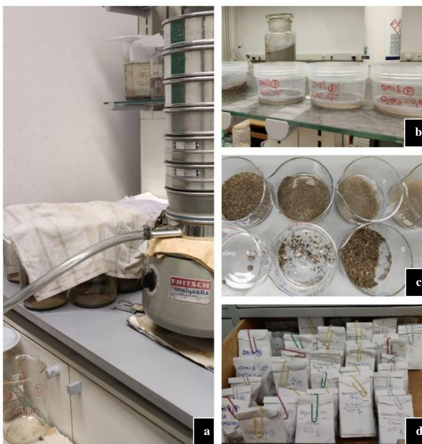
Slika 4. Analiza veličine zrna na GO; a - tresilica sa sitima za skupljanje različitih frakcija i crijevo za odvod frakcije <0,063 mm u posebnu staklenku; b – sušenje uzoraka; c – osušeni uzorci; d – uzorci spremljeni za daljnje analize.
