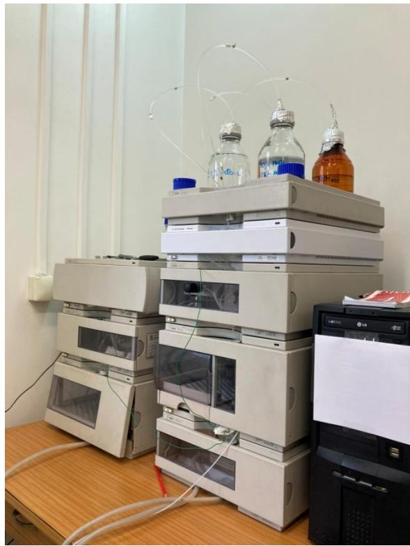
Slika 6. HPLC uređaj Agilent 1100 Series s UV/VIS detektorom.
