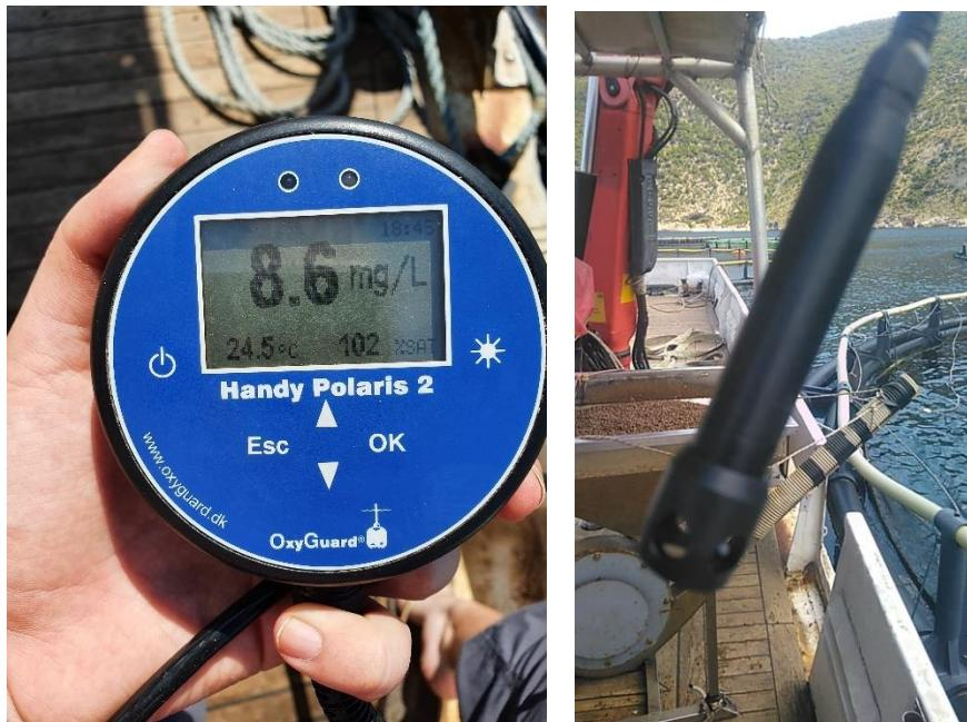
Slika 9. Ručna sonda za mjerjenje temperature te koncentracije i postotka zasićenja mora kisikom
