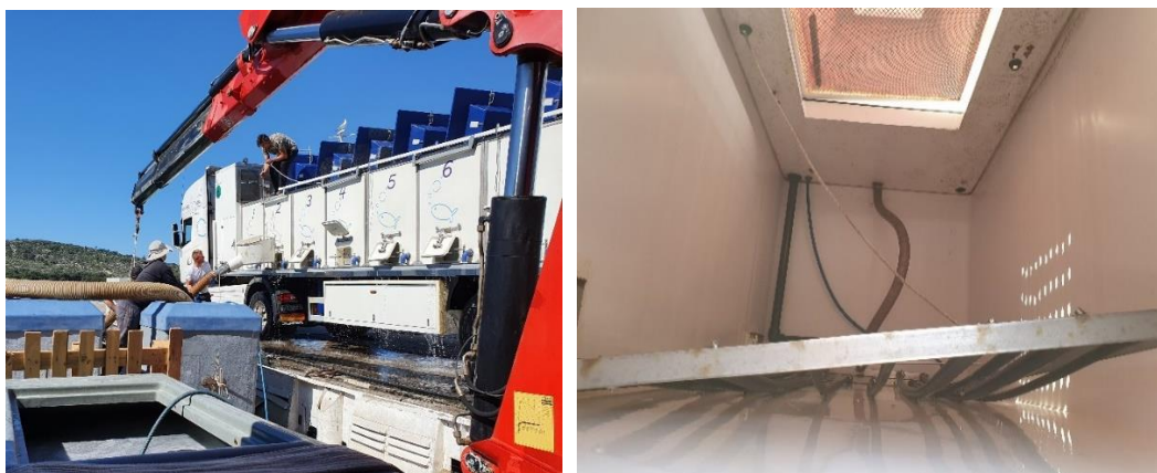
Slika 11. Transportni tankovi na kamionu, te unutrašnjost tanka
