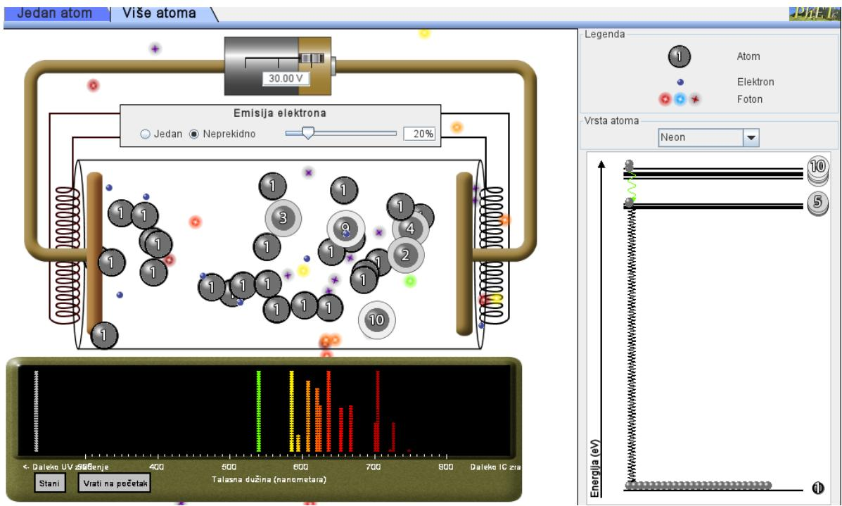
**Slika 7.7.** Prikaz simulacije Phet: Izbojna lampa s više atoma neon i prikaz dobivanja emisijskog spektra neon-a [52]
