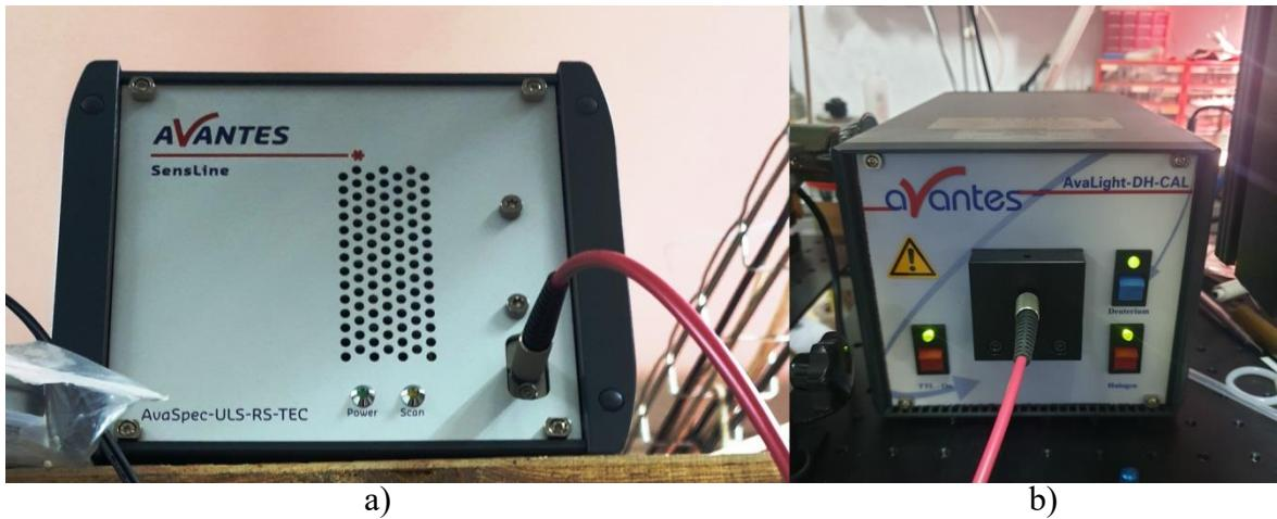
**Slika 5.4.** AVANTES a) spektrometar b) kalibracijska lampa
