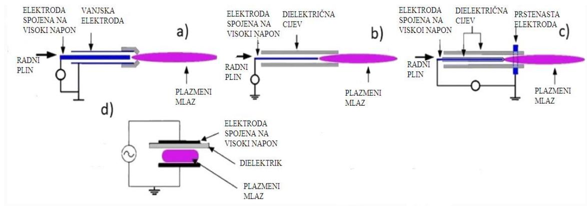
**Slika 3.1.** Shematski prikaz konfiguracija elektroda atmosferskog plazmenog mlaza: a) DFE b) SE
