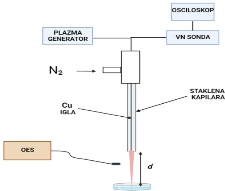
Slika 5.1. Shematski prikaz eksperimentalnog postava
