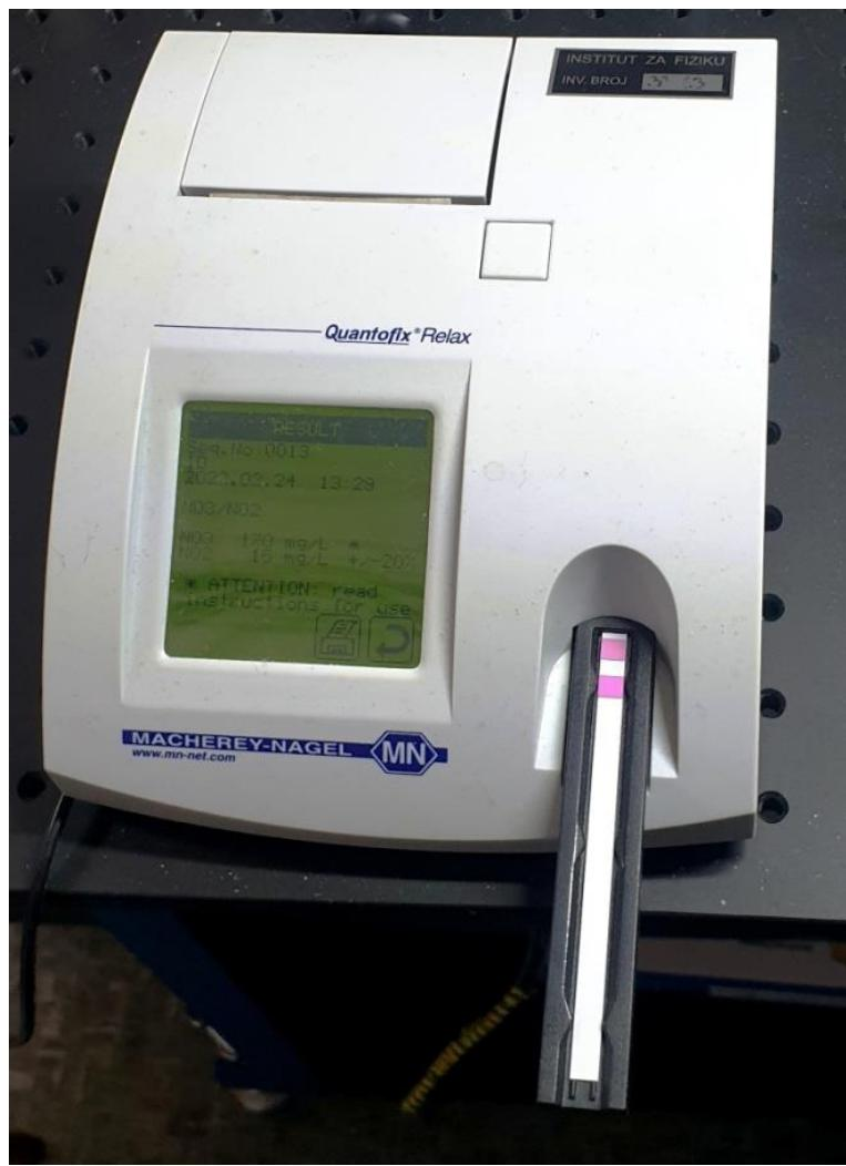
**Slika 5.7.** Fotografija analize nitrit/nitrat testne trakice QUANTOFIX® Relax uređajem
