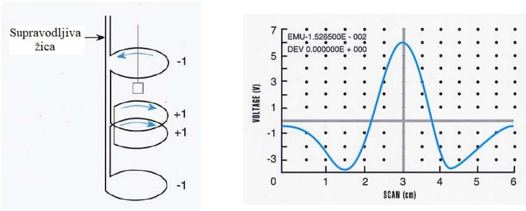
Slika 3.5: Detekcijska zavojnica i izlazni signal SQUID-a [23]
