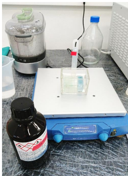
Slika 12. Ispiranje uzoraka u 1xTBS puferu koji održava odgovarajuću pH-vrijednost za očuvanje fizioloških osobina tkiva. Ispiranjem se uklanjaju i ostatci reagensa korištenih tijekom pojedinog koraka u protokolu metode imunohistokemije.
