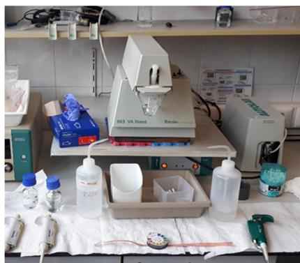
Slika 18. Metrohm Autolab modularni potenciostat/galvanostat PGSTAT204 i VA Stand 663 troelektrodni sustav korišten za analizu adsorbiranih metala na plastičnim česticama, Institut Ruđer Bosković, Zavod za istraživanje mora i okoliša, Laboratorij za fizičku kemiju tragova.
