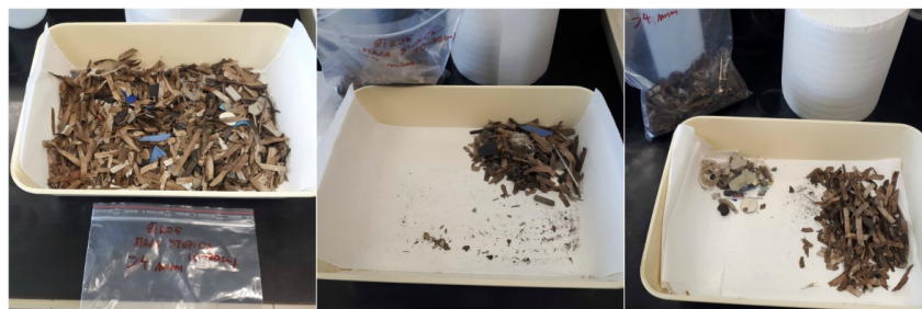
Slika 9. Podjela materijala većeg od 4 mm na četiri dijela i izdvajanje plastičnih čestica iz jednog dijela.
