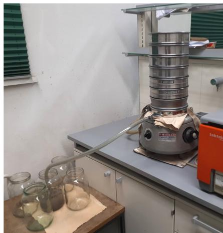
Slika 10. Standardna Retsch ASTM sita na Fritches Analysette tresilici, Geološko-paleontološki zavod PMF-a.
