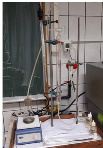
Slika 12. Scheibler-ova aparatura za kalcimetru, Mineraloško-petrografski zavod PMF-a.
