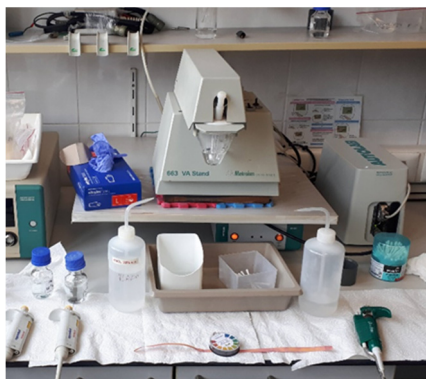
Slika 18. Metrohm Autolab modularni potenciostat/galvanostat PGSTAT204 i VA Stand 663 troelektrodni sustav korišten za analizu adsorbiranih metala na plastičnim česticama, Institut Ruđer Bosković, Zavod za istraživanje mora i okoliša, Laboratorij za fizičku kemiju tragova.
