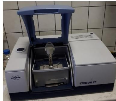
Slika 17. Tensor 27 spektrometar za snimanje FTIR spektra u ATR-u, Mineraloško-petrografski zavod PMF-a.
