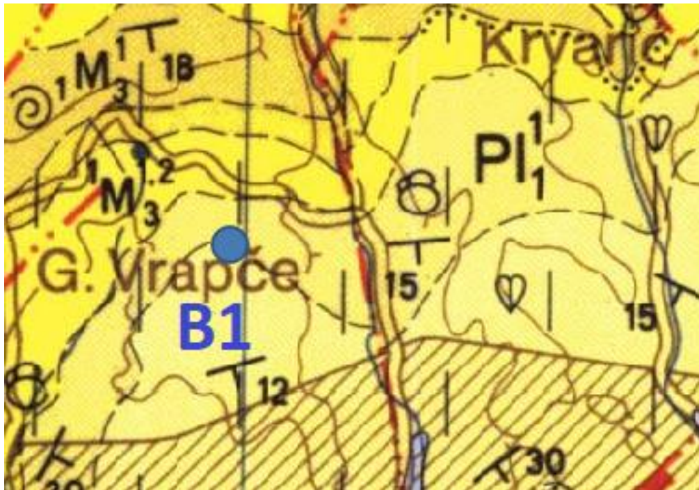
Slika 3.2. Isječak iz osnovne geološke karte SFRJ list Zagreb mjerila 1:100 000 uz pripadajući tumač simbola. Točkom i oznakom B1 prikazana je bušotina iz koje su uzeti uzorci (modificirano prema ŠIKIĆ i sur., 1977). Prema novoj stratigrafskoj podjeli (PAVELIĆ i KOVAČIĆ, 2018) najmlađi pliocen, na karti prikazan simbolom Pl^1 , danas se svrstava u najgornji miocen.
