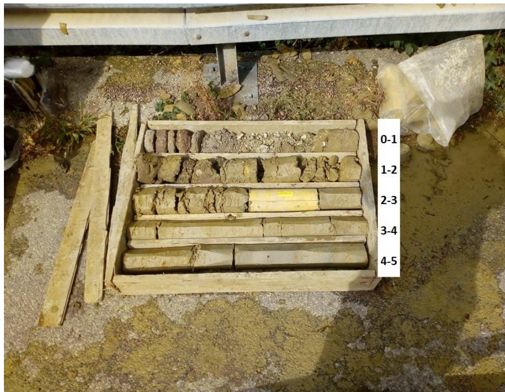
Slika 3.4. Jezgre prvog intervala bušenja od 0 do 5 metara. Brojevi na bijeloj podlozi predstavljaju dubinu uzorkovanja u metrima [m].
