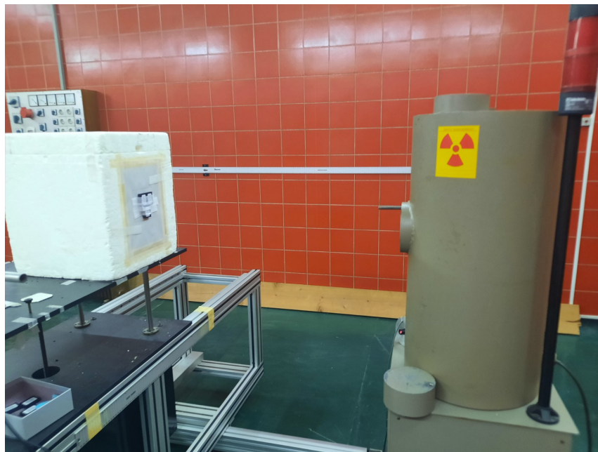
Slika 3.9: Izvor \gamma -zračenja ^{137}\text{Cs} korišten u radu. Lijevo od izvora se vide dozimetri pričvršćeni na kocku od stiropora.
