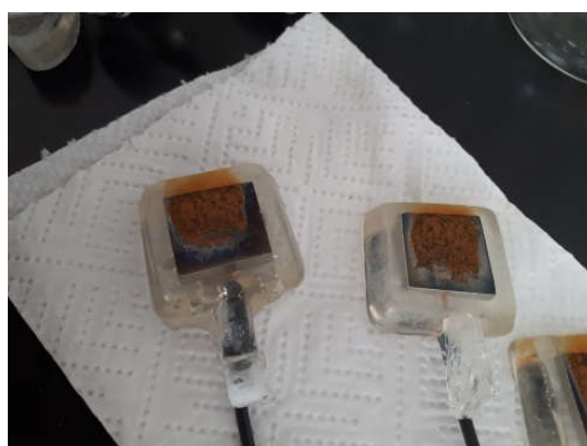
Slika 1. Izgled uzorak ugljičnog čelika prije ispitivanja
