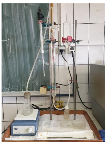
Slika 11. Aparatura za određivanje karbonatne komponente
