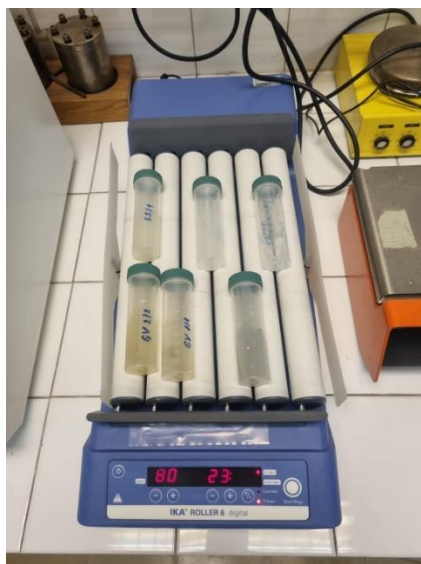
Slika 10. Tresilica na kojoj su uzorci ostavljeni prije početka mjerenja
