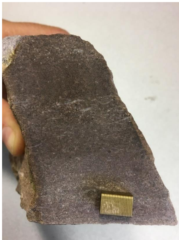
Slika 8. Makro uzorak J-1. Mjerilo prikazuje 1 cm.
