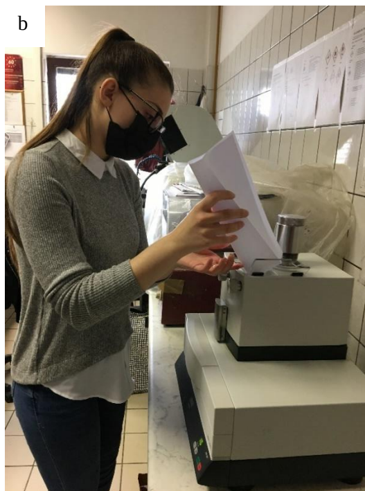
Slika 5. Priprema uzoraka u laboratoriju: a) usitnjavanje uzorka, b) drobljenje uzorka
