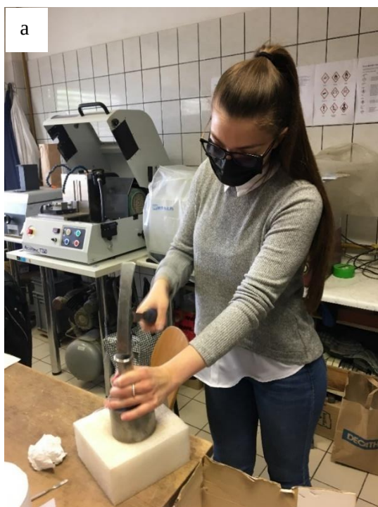
Slika 5. Priprema uzoraka u laboratoriju: a) usitnjavanje uzorka, b) drobljenje uzorka
