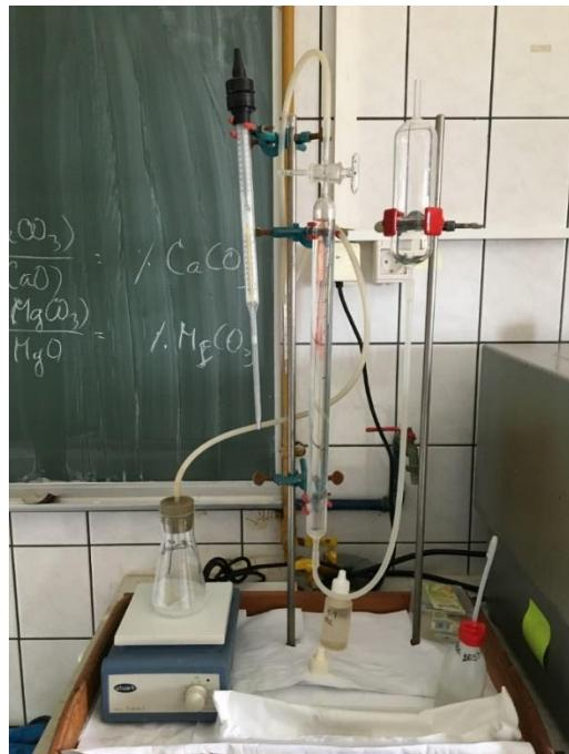
Slika 6. Aparatura za kalcimetriju, Mineraloško-petrografski zavod PMF-a
