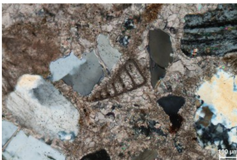
Slika 18. Fosilni ostatak bentičke foraminifere (F) (analizator uključen).
