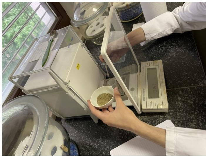
Slika 8. Vaganje praškastog uzorka za analizu sadržaja CaCO<sub>3</sub>.
