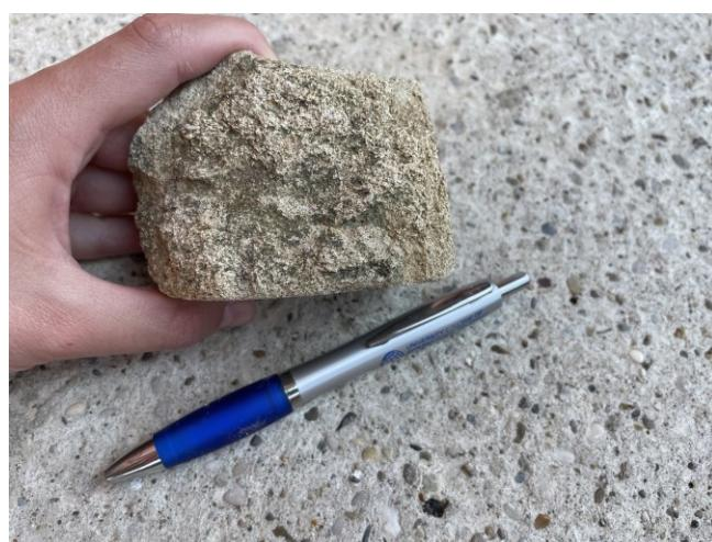
Slika 6. Uzorak čvrsto litificiranog pješčenjaka uzet za laboratorijska istraživanja.
