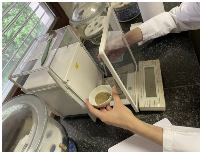
Slika 8. Vaganje praškastog uzorka za analizu sadržaja CaCO 3 .
