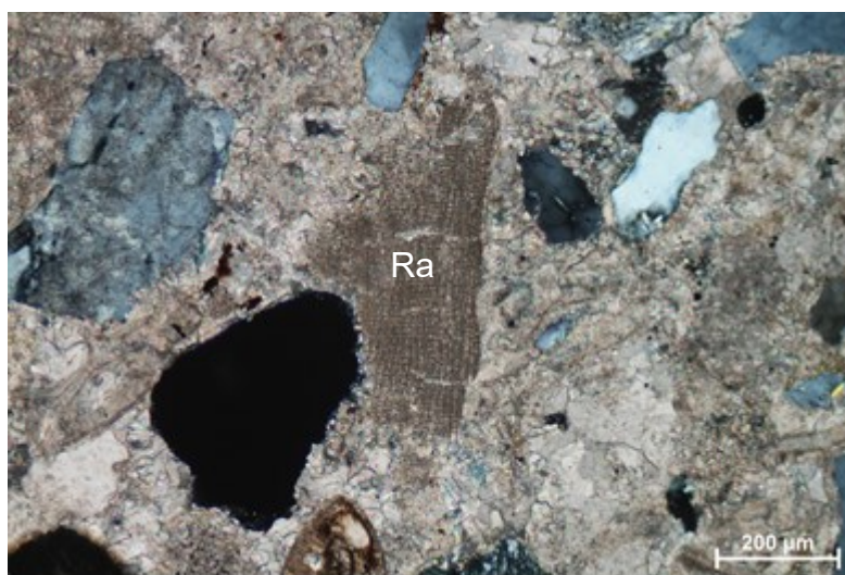
Slika 16. Fragment crvene alge tipične „mrežaste“ strukture (Ra) (analizator uključen).
