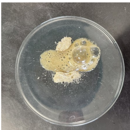
Slika 10. Fotografija burne reakcije uzorka i otopine HCl-a koja upućuje na prisutnost kalcita.
