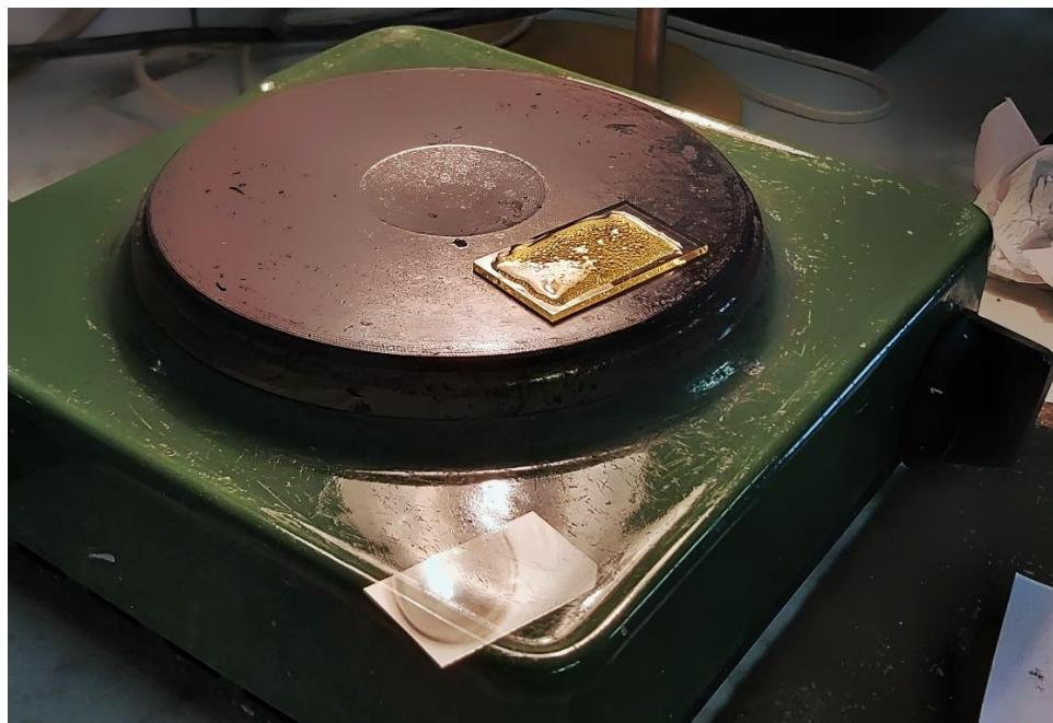
Slika 9. Zagrijavanje kanada balzama i uzorka na predmetnom stakalcu prilikom izrade mikroskopskog preparata.
