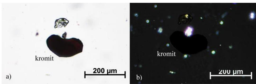
Slika 12. Fotomikrografija kromita s isključenim (a) i uključenim analizatorom (b).
