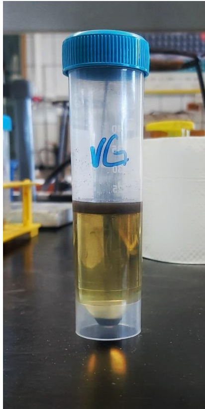
Slika 8. Kiveta s razdvojenom teškom i lakom mineralnom frakcijom u SPT-u nakon centrifuge.
