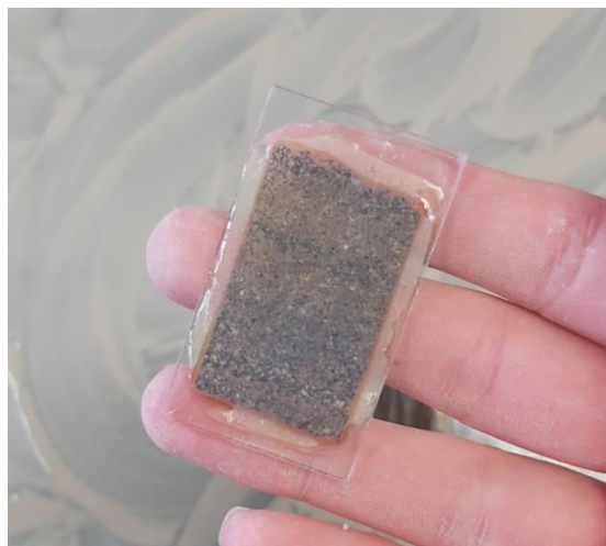
Slika 7. Izbrusak pješčenjaka nakon što je obrađen grubim brusnim prahom. Širina fotografije je 7 cm.
