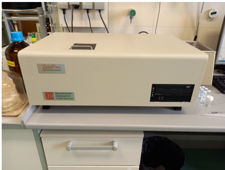
Slika 13. Uređaj za dinamičko raspršenje svjetlosti Brookhaven 90 Plus Particle Size Analyzer (Brookhaven Instruments Corporation, Sjedinjene Američke Države).
