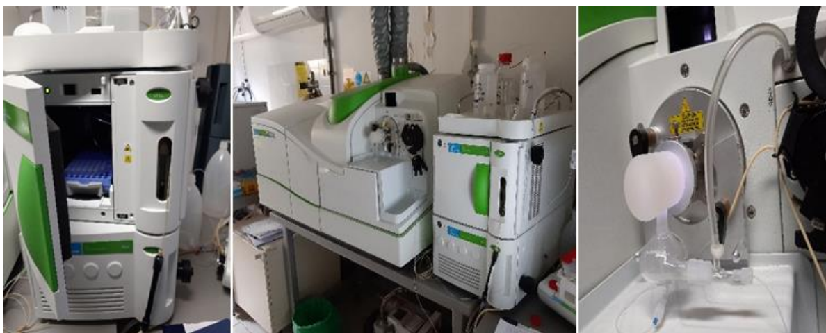
Slika 13. Vezani sustav UHPLC–ICP–MS.
