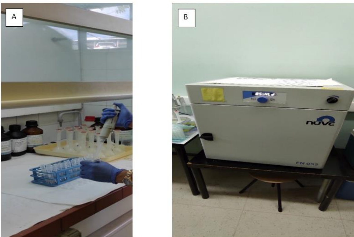
Slika 8. Razgradnja mišića štuke za potrebe analize metala, dodavanje kiseline (A) (Autor fotografije: Tatjana Mijošek) i grijanje u sušioniku (B).
