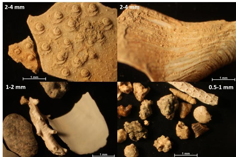
Slika 10 - Mikroskopski prikaz frakcija uzorka FPP8
