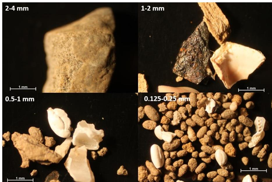
Slika 12 - Mikroskopski prikaz frakcija uzorka FPP2
