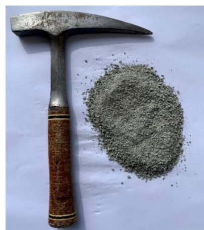
Slika 6. Uzorak usitnjen u fragmente veličine pijeska i sitnije geološkim čekićem.
