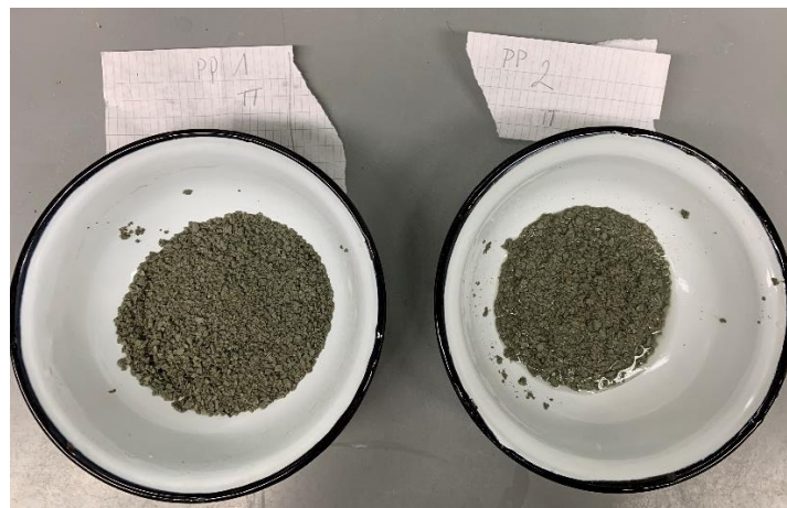
Slika 9. Osušeni talog zaostao nakon ispiranja i prosijavanja podijeljen u dva pod-uzorka. Vide se krupni fragmenti.
