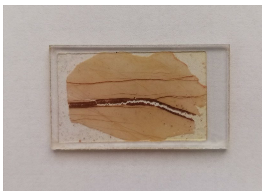
Slika 16. Makroskopski izgled Preparata broj 4 nakon provedenog postupka bojenja karbonata; stijena je ostala nebojena, a žilica u njoj je poprimila tamno ljubičasto obojenje
