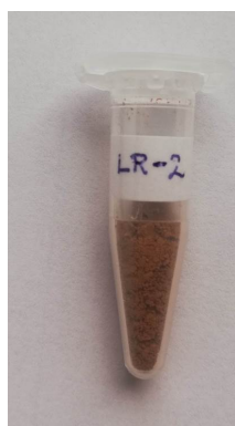
Slika 14. Uzorak LR-2 za difraktometriju; predstavlja netopivi ostatak pažljivo izdvojene žilice smeđe boje otopljen klorovodičnom kiselinom (1:10)
