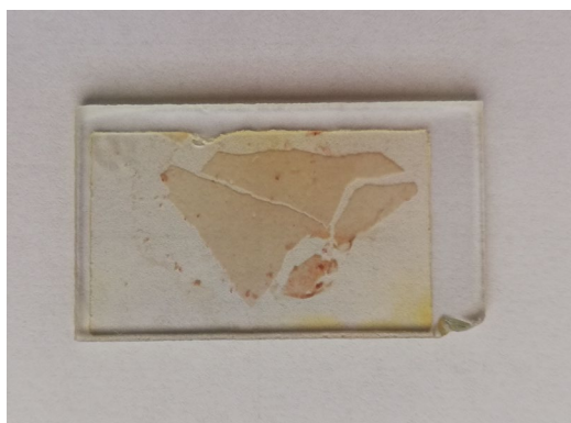
Slika 15. Makroskopski izgled Preparata broj 3 nakon provedenog postupka bojenja karbonata; stijena domaćin cinabarita je ostala nebojena
