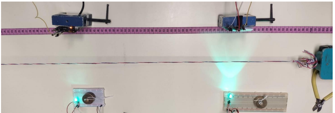
Slika 4.18 Prikaz pokusa s dvostrukim vremenskim vratima
