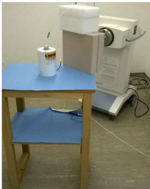
Slika 12. Postavljanje ionizacijske komore bunarskog tipa u položaj za mjerenje RAKR ^{192}\text{Ir} [27].
