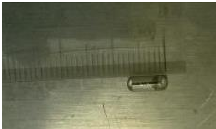
Slika 10. Izvor ^{137}\text{Cs} koji se koristi za provjeru konstantnosti odziva komore. Dimenzije izvora su: aktivna duljina 1,5 mm, ukupna duljina 8 mm, promjer 3,2 mm [27].
