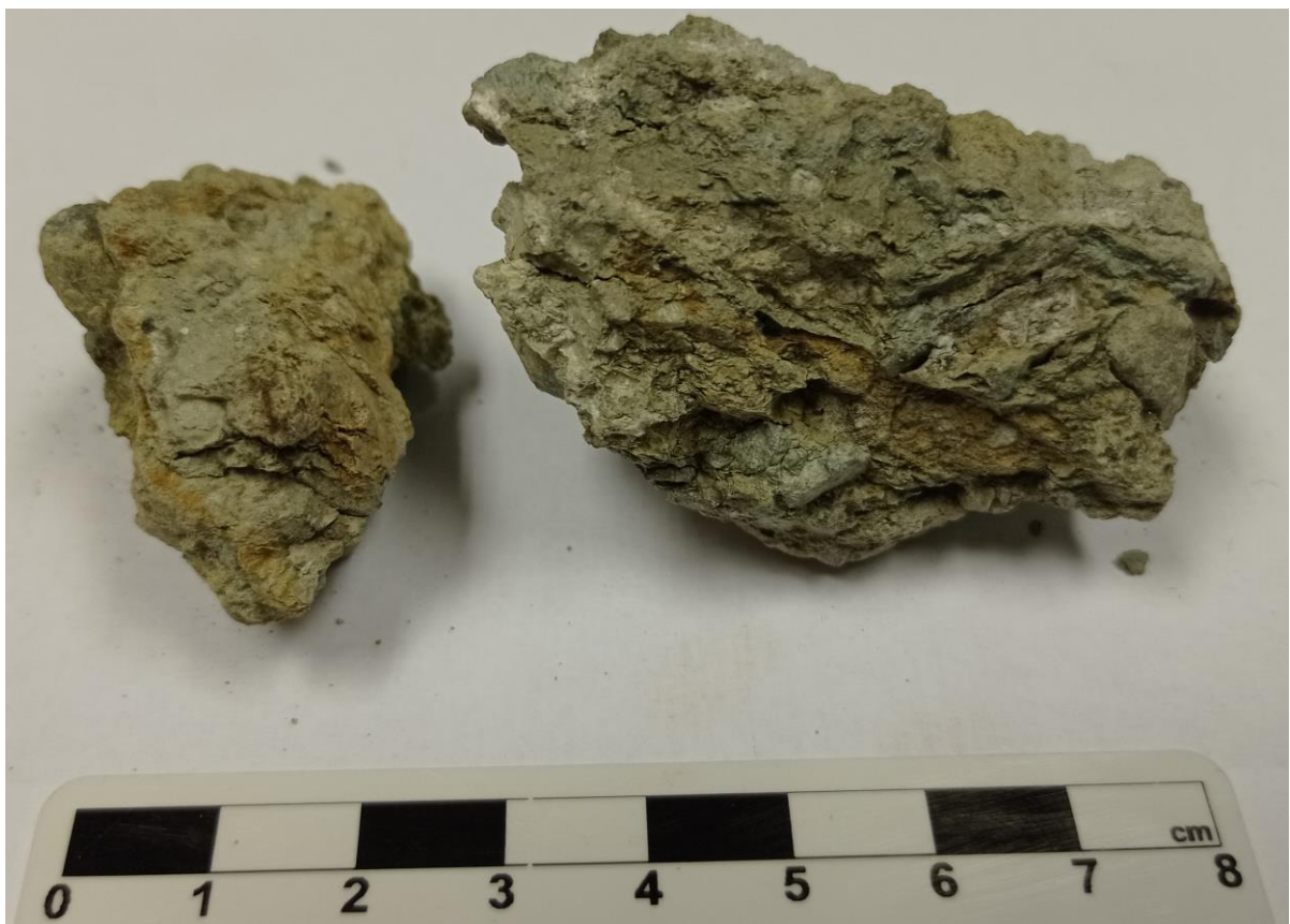
Slika 18. Uzorak Bz1 na kojem je vidljivo blago mikroboranje (desno).
