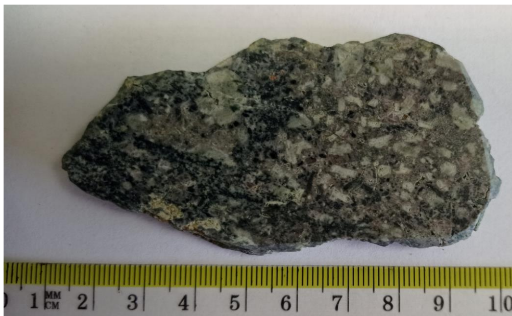
Slika 26. Uzorak Bz10 vidljive afanitske strukture.
