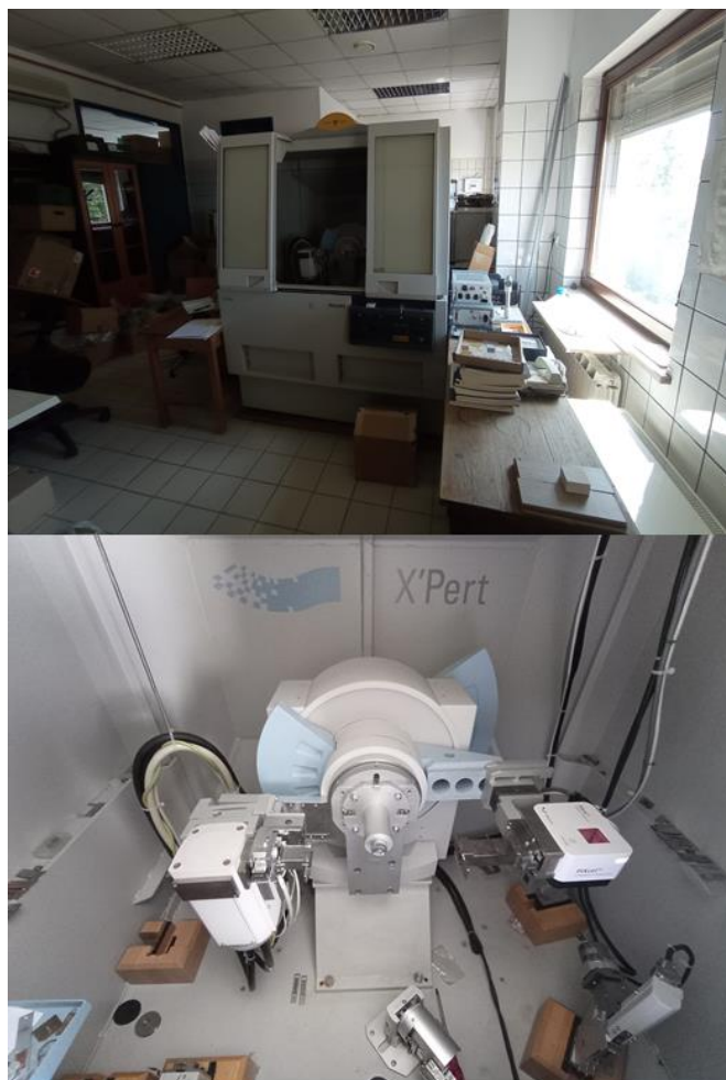
Slika 7. XRD instrument korišten za kvalitativnu analizu uzoraka u prahu.
