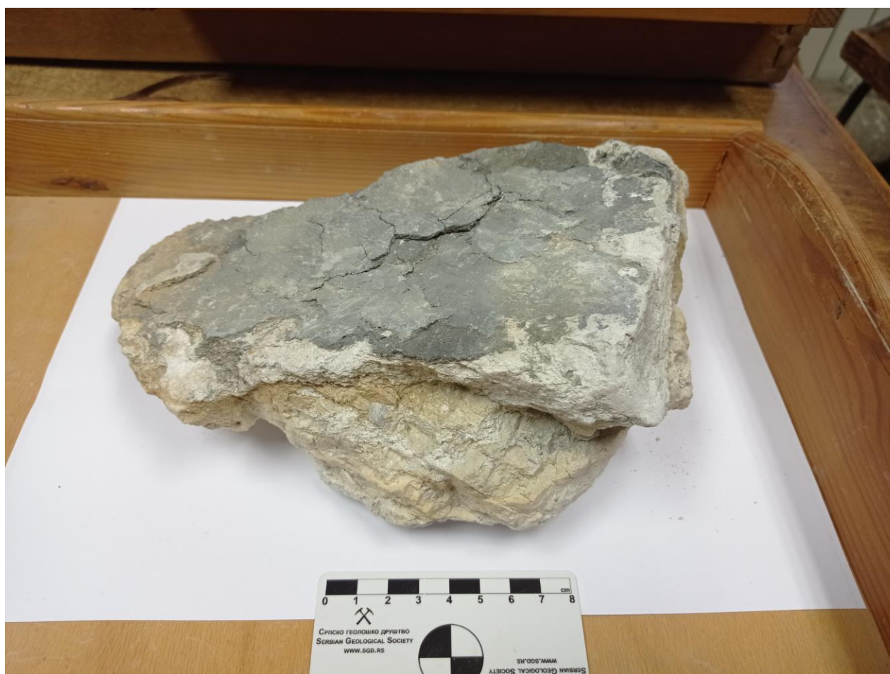
Slika 13. Uzorak Bi3 - agregat sa sivom, žutom i bijelom fazom.
