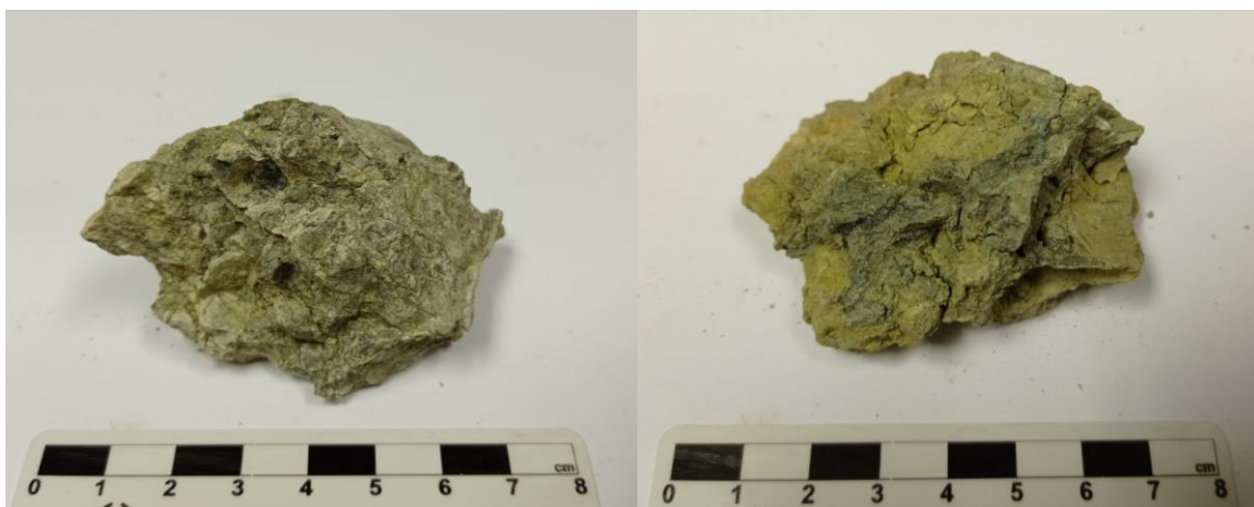
Slika 21. Uzorak Bz4 je izmijenjeni andezit na kojem su vidljivi ksenoblasti amfibola (lijevo) i izmijenjena andezita (desno).
