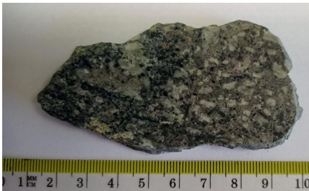
Slika 26. Uzorak Bz10 vidljive afanitske strukture.
