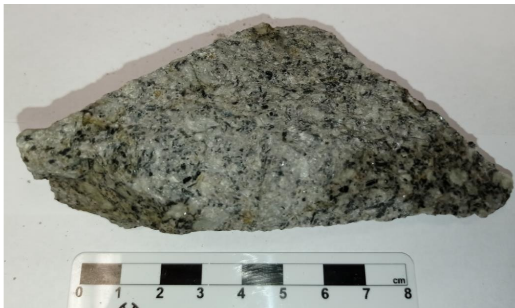
Slika 27. Uzorak Bz11 pokazuje tipičnu porfirnu strukturu.
