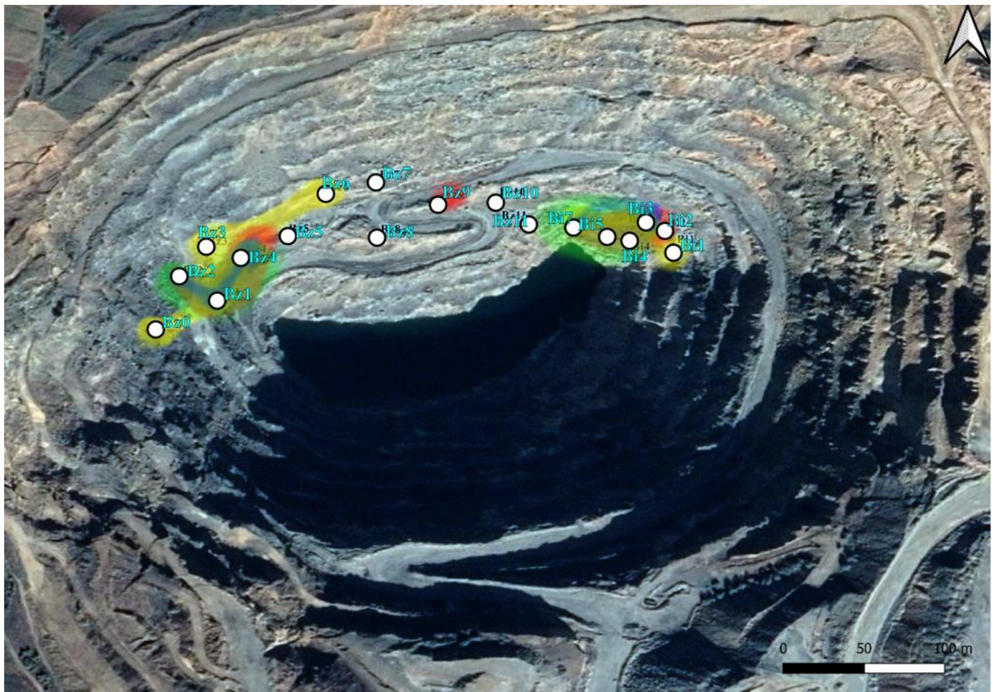
Slika 64. Prikaz preklapljenih alteracija u rudniku (žuto-kalijska, crveno-sericitna, plavo-argilitna, zeleno-propilitna)
