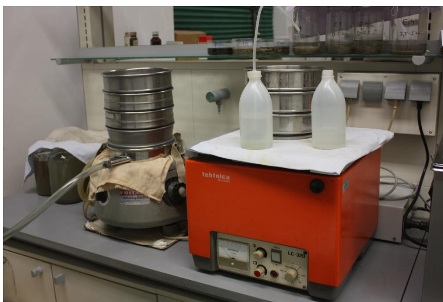
Slika 7. Sustav sita tijekom mokrog sisanja
