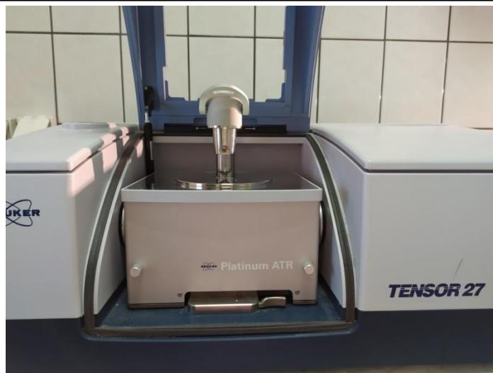
Slika 13. Tensor 27 spektrometar
