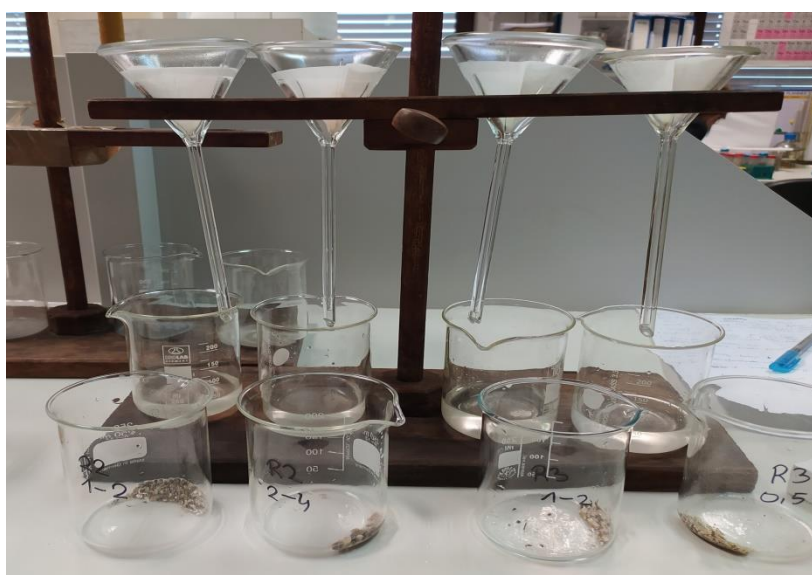
Slika 11. Filtracija sedimenta nakon tretiranja vodikovim peroksidom
