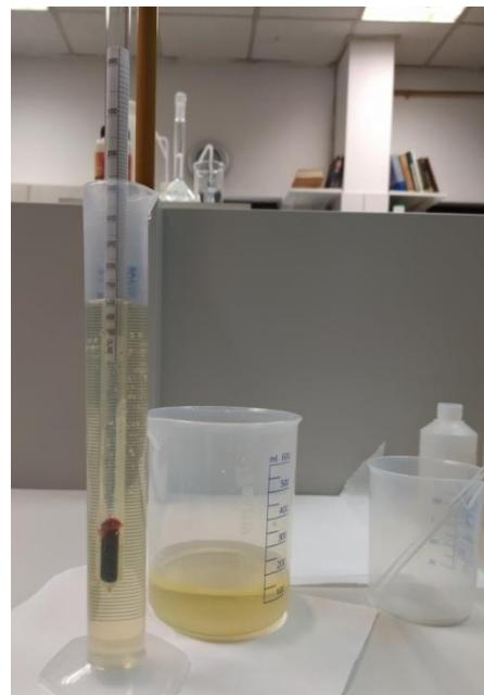
Slika 12. Mjerjenje gustoće otopine areometrom
