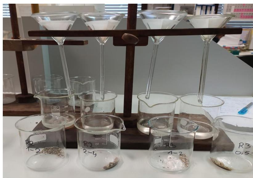
Slika 11. Filtracija sedimenta nakon tretiranja vodikovim peroksidom
