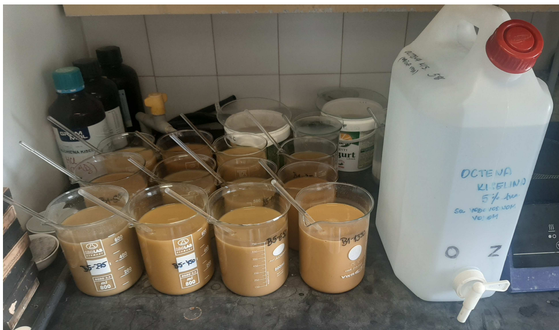
Slika 20. Uklanjanje karbonatne komponente dodatkom 5%-tne octene kiseline.
