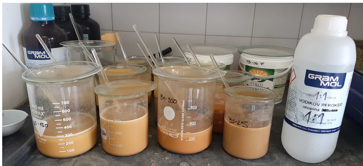
Slika 21. Uklanjanje organske tvari dodatkom 15%-tnog vodikovog peroksida.
