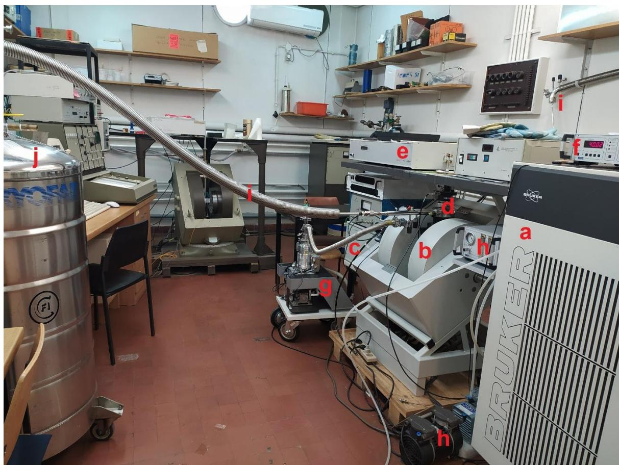
Slika 18. EPR spektrometar Bruker Elexsys 580 FT/CW u Laboratoriju za magnetske rezonancije Instituta Ruđer Bošković u Zagrebu. Na slici su označeni dijelovi spektrometra.
