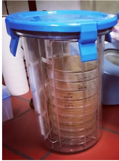
Slika 7 Posuda za anaerobnu inkubaciju
