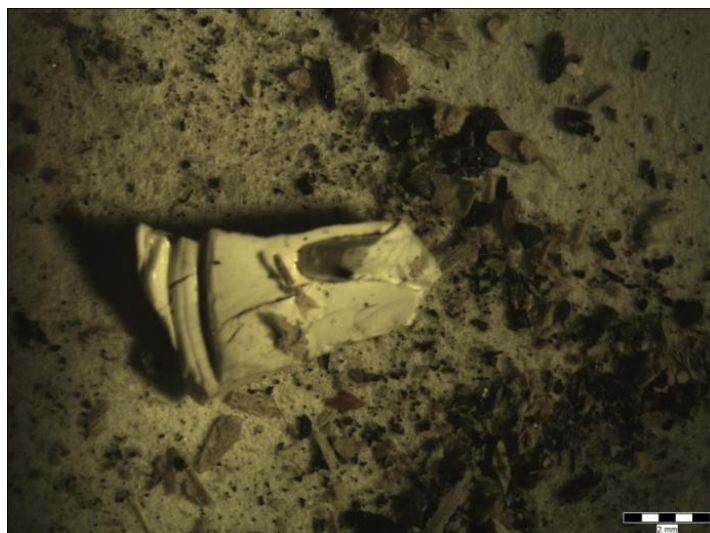
Slika 22. Čestica mikroplastike identificirana kao polimetil metakrilat (uzorak: 1.12. V1_H 2 O 2 _1) (Fotografija: Dunja Jurina).
