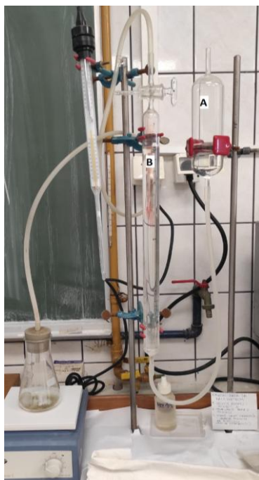
Slika 10. Scheiblerov kalkimetar s označenom pomičnom cijevi A i graduiranom cijevi B s ventilom. (Fotografija: Dunja Jurina)
