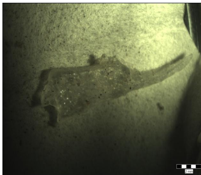
Slika 21. . Čestica mikroplastike identificirana kao polistiren (uzorak: 19.11. V2_H 2 O 2 ) (Fotografija: Dunja Jurina)..
