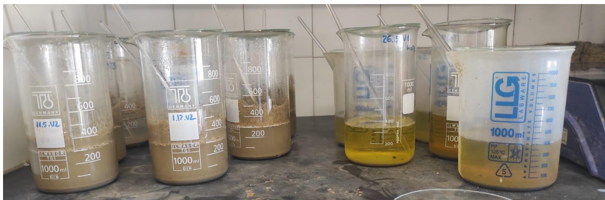
Slika 8. Uzorci tretirani vodikovim peroksidom (lijevo) i uzorci tretirani klorovodičnom kiselinom nakon tretiranja vodikovim peroksidom (desno) (Fotografija: Dunja Jurina)
