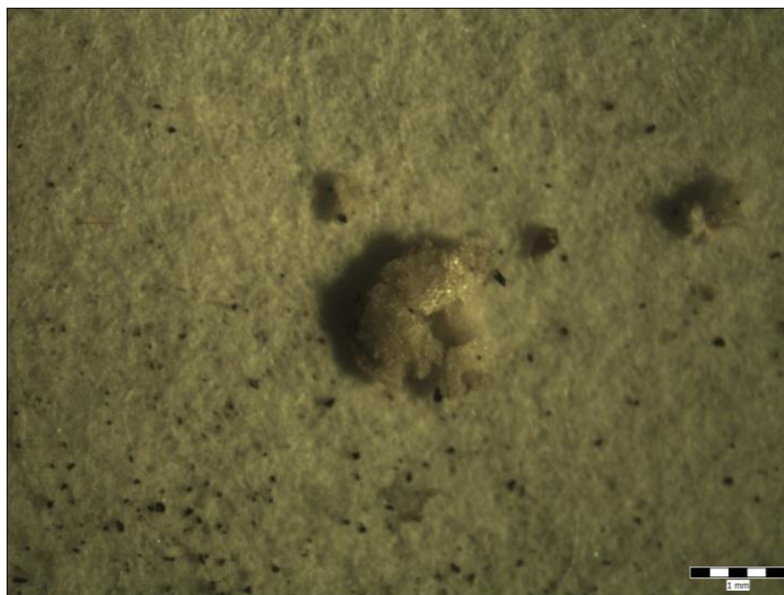
Slika 20. Čestica mikroplastike identificirana kao polistiren (uzorak: 1.12. V1_H 2 O 2 ) (Fotografija: Dunja Jurina).
