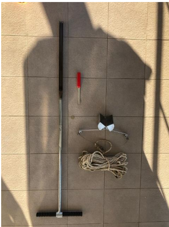
Slika 5. Oprema korištena za uzorkovanje. T-štap za jezgrovanje, nož, grabilica i konop. Fotografirao Luka Đukan.
