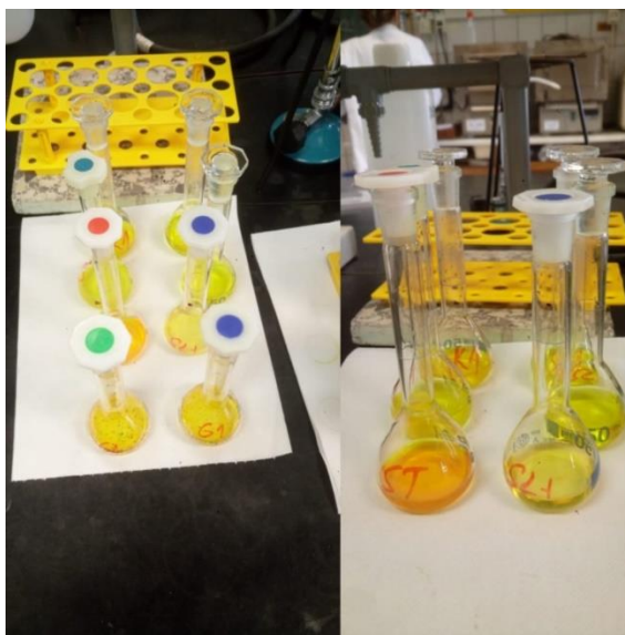
Slika 13. Dekantirana otopina uzoraka četvrtog koraka BCR protokola u tikvice od 50 ml, laboratorij Mineraloško-petrografskog zavoda Geološkog odsjeka Prirodoslovno-matematičkog fakulteta u Zagrebu.
