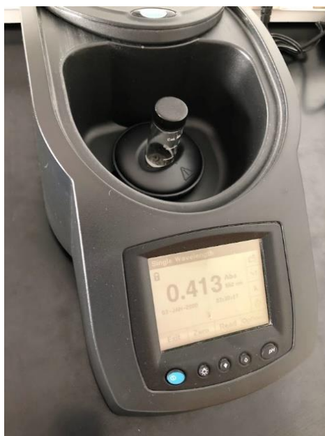
Slika 7. Prikaz mjerenja optičke gustoće bakterijske suspenzije.
