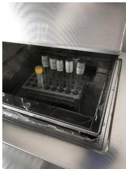
Slika 8. Pasterizacija serije decimalnih razrjeđenja na 80 °C.
