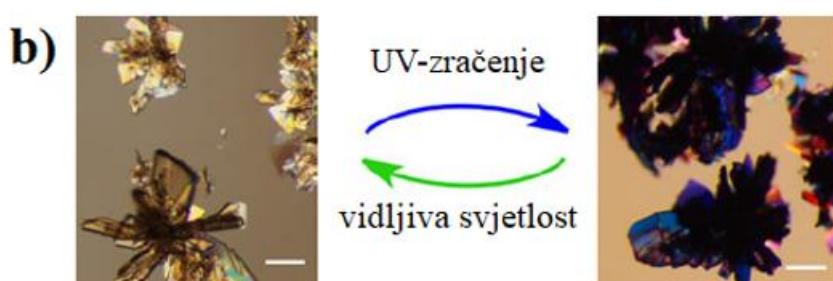
Slika 10. a) Struktura fotoaktivne molekule **L<sub>0</sub>** b) Promjena boje kristala fotoaktivnog PCP-a uslijed izlaganja UV-zračenju te vidljivoj svjetlosti.<sup>16</sup> (Ilustracija je preuzeta i prilagođena prema literaturnom izvoru.)
