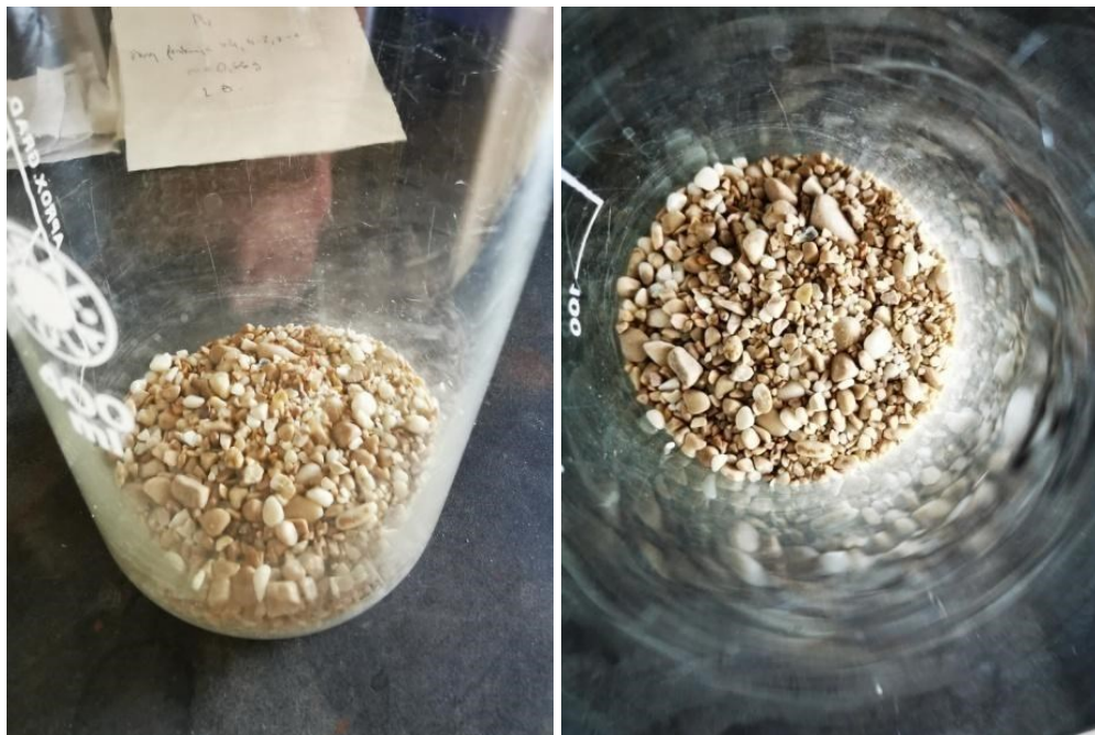
Slika 18. Uzorak P1 koji je za potrebe analiza, zbog veličine čestica, bilo potrebno prvo drobiti a zatim samljeti.
