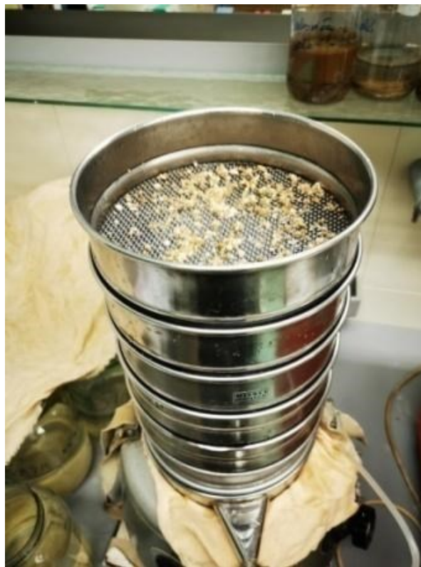
Slika 13. Tresilica Fritsch Analysette sa setom od 7 različitih Retsch ASTM sita.
