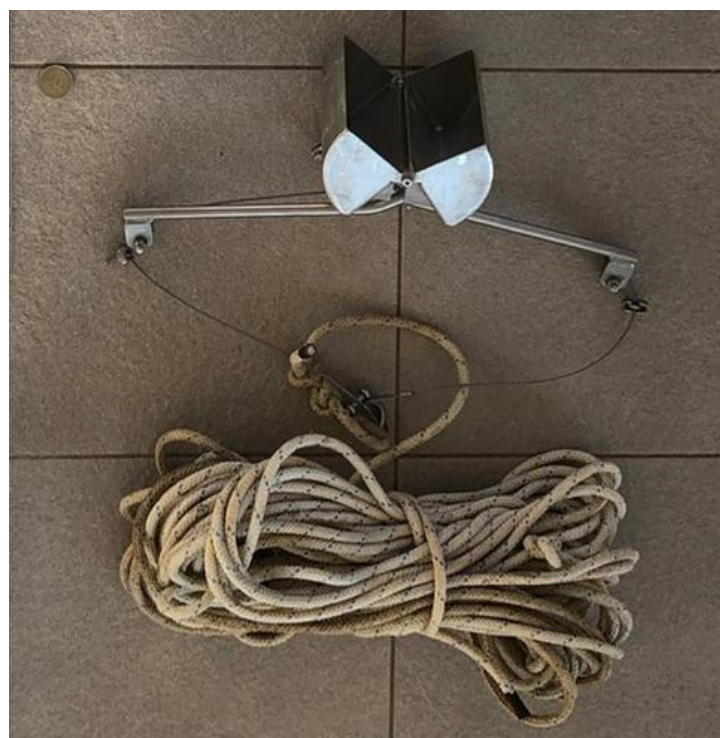
Slika 8. Van Veenovo grabilo korišteno za uzimanje uzorka sedimenta sa morskoga dna.
