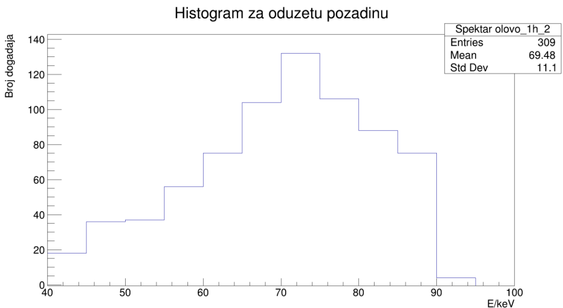
Slika 4.19 Uvećani spektar olova izmjeren u vremenskom intervalu od 60 minuta
