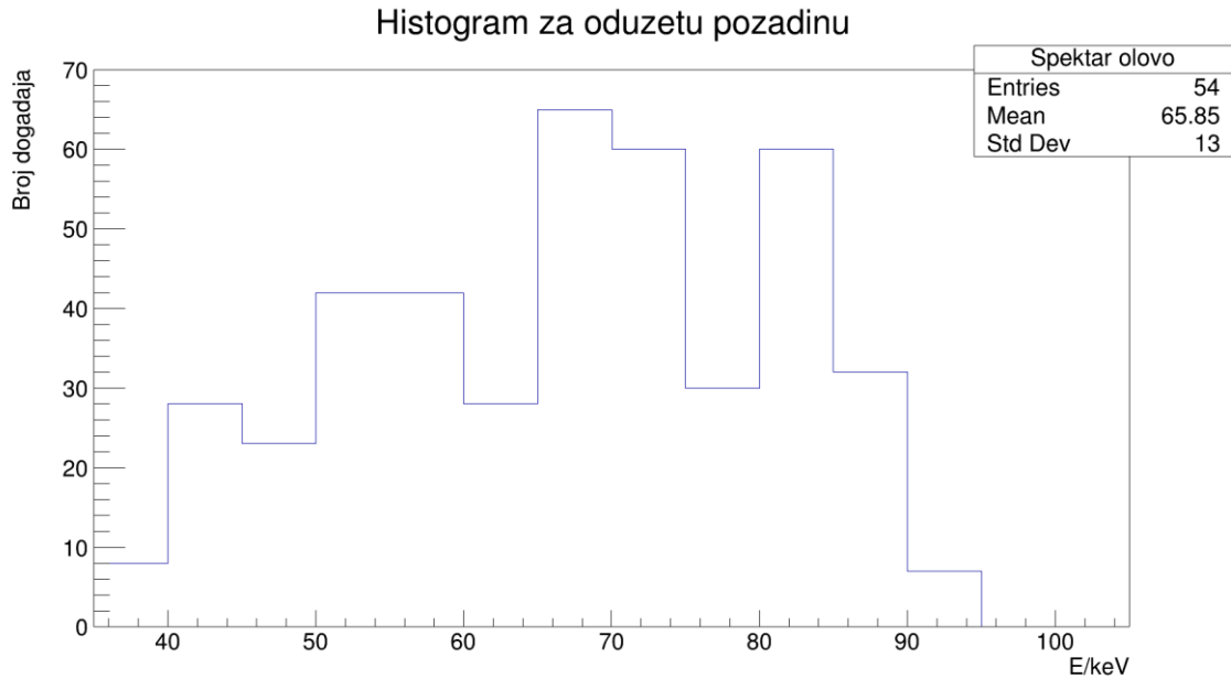
Slika 4.15 Uvećani dobiveni spektar olova snimljen u 30 minuta
