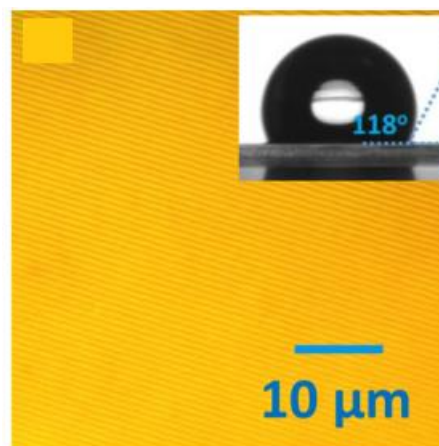
Slika 16: Utisnuti PDMS sloj uslikan optičkim mikroskopom. Boja je dobivena interferencijom svjetlosti zbog uzorka sloja. Umanjena slika pokazuje kontaktni kut kapljice vode sa slojem (~118°) [33].
