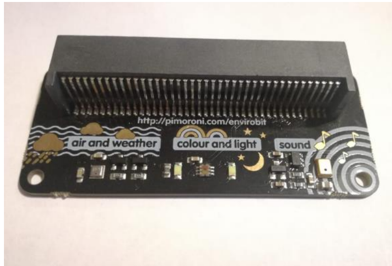
Slika 4.2 Enviro:bit pločica. Pozicije pojedinih senzora naznačene su na pločici.
