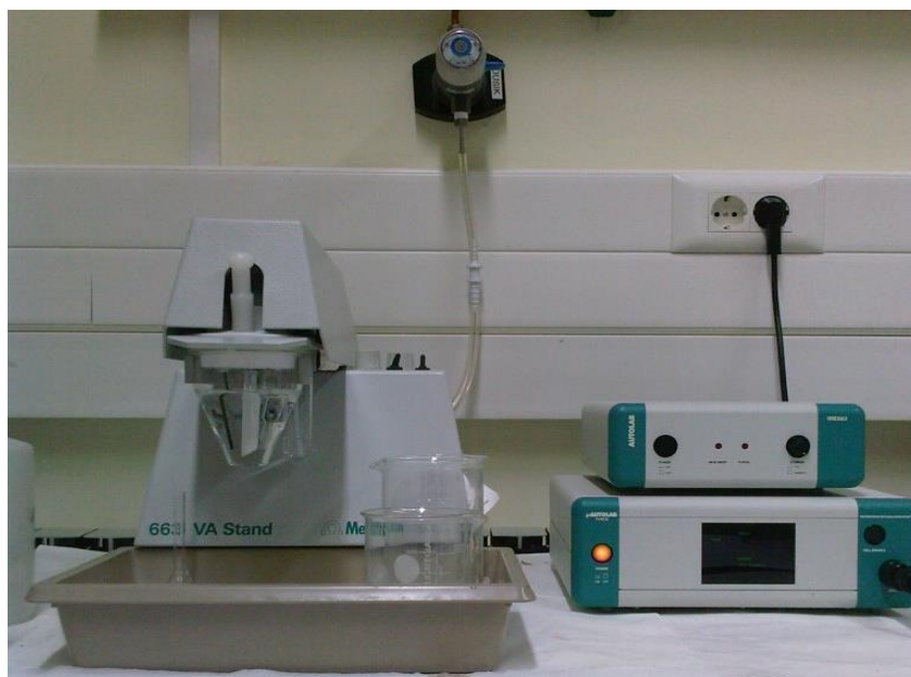
Slika 3.3. Mjerni sustav korišten za voltametrijska mjerenja: 663VA Stand troelektrodni sustav povezan s \mu AUTOLAB potenciostatom/galvanostatom i IME jedinicom.
