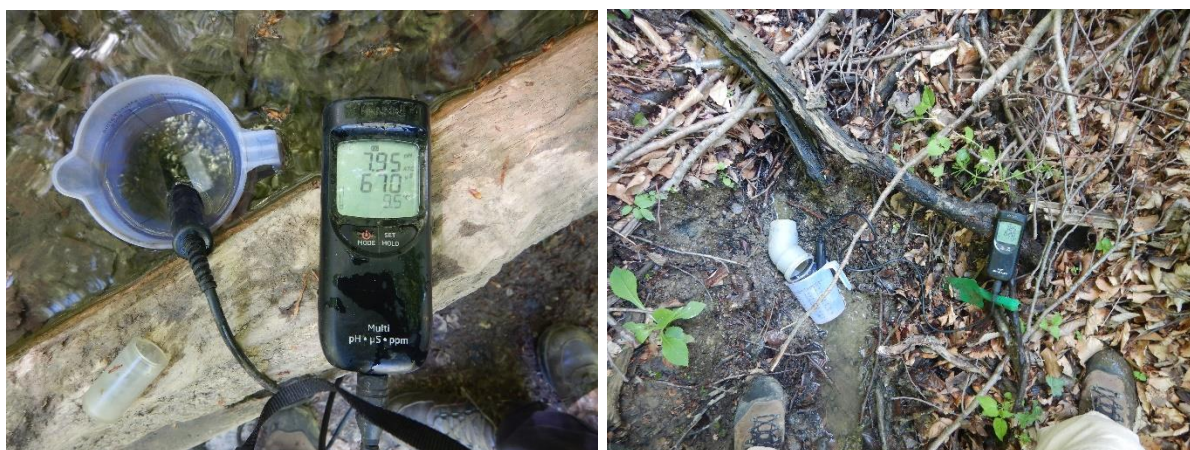
Sl. 7. i 8. Mjerenje odabranih hidroloških pokazatelja multimetrom tvrtke Hanna Instruments®.
