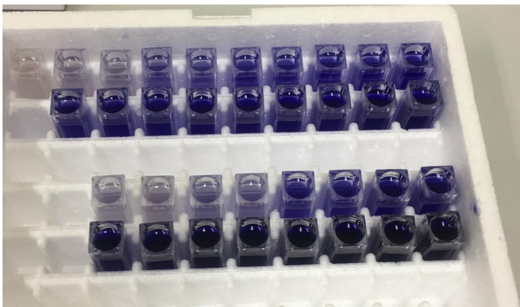
Slika 22. Prikaz rezultata za baždarnu krivulju FRAP metode (Izvor: vlastita fotografija ; slikano u laboratoriju Metris u Puli)
