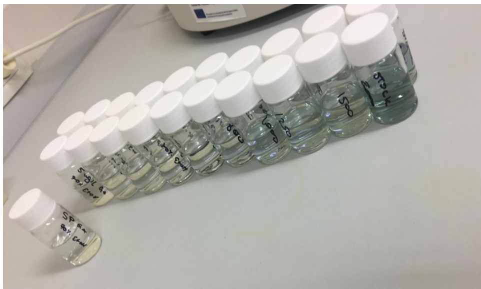
Slika 20. Prikaz izrađenih razrjeđenja za izradu baždarne krivulje galne kiseline (Izvor: vlastita fotografija ; slikano u laboratoriju Metris u Puli)
