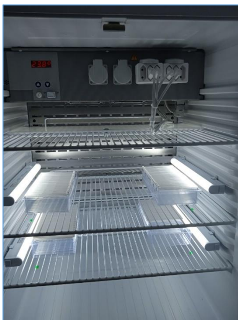
Slika 10. Unutrašnjost inkubatora TC 135 S (Aqualytic, Njemačka) s uzorcima. Uzorci su inkubirani na 23 °C ( \pm 2 °C) s kontinuiranim osvjetljenjem 10 000 lux (fotografiju izradila: dr. sc. Želimira Cvetković).
