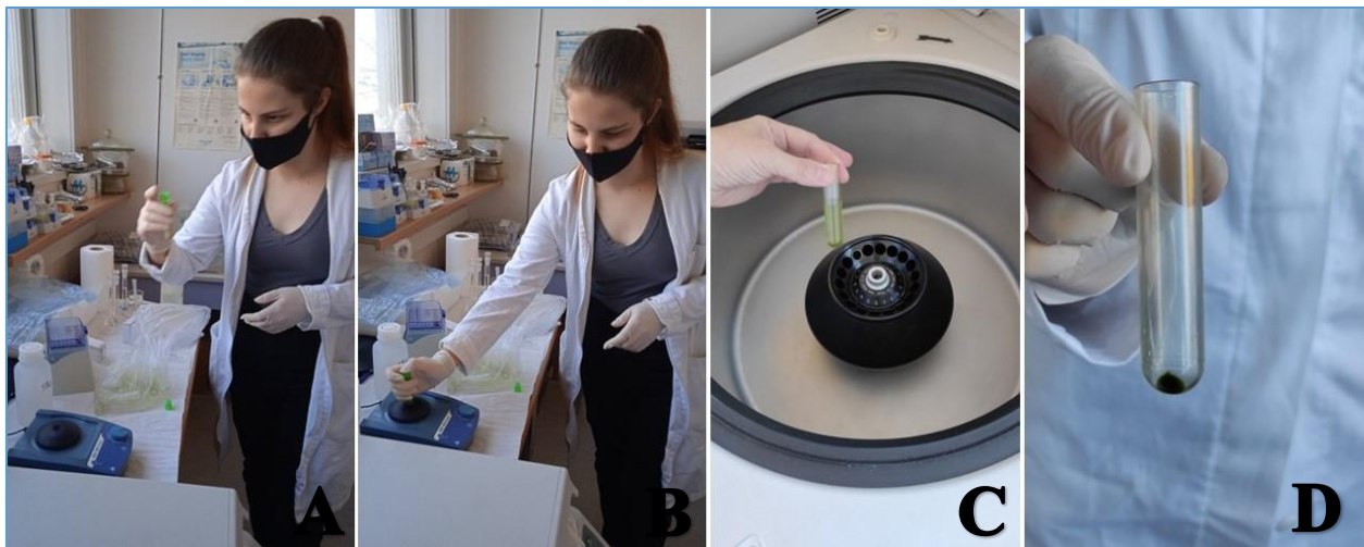
Slika 6. Deimobilizacija algi. Kako bi se dobila čista suspenzija algi, potrebno je ukloniti sav medij za imobilizaciju: A) uklanjanje medija koji imobilizira alge, B) vorteksiranje, C) centrifugiranje homogene suspenzije, D) talog (suspenzija algi) dobiven nakon izlivanja supernatanta (fotografije izradila: dr. sc. Želimira Cvetković).
