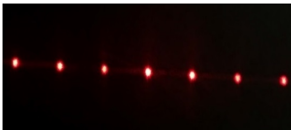
Slika 1.14: Uzorak dobiven interferencijom crvene svjetlosti na optičkoj rešetki [7]
